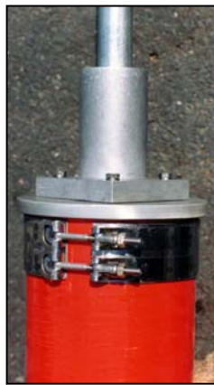
LIR Mast Interface Subassembly
